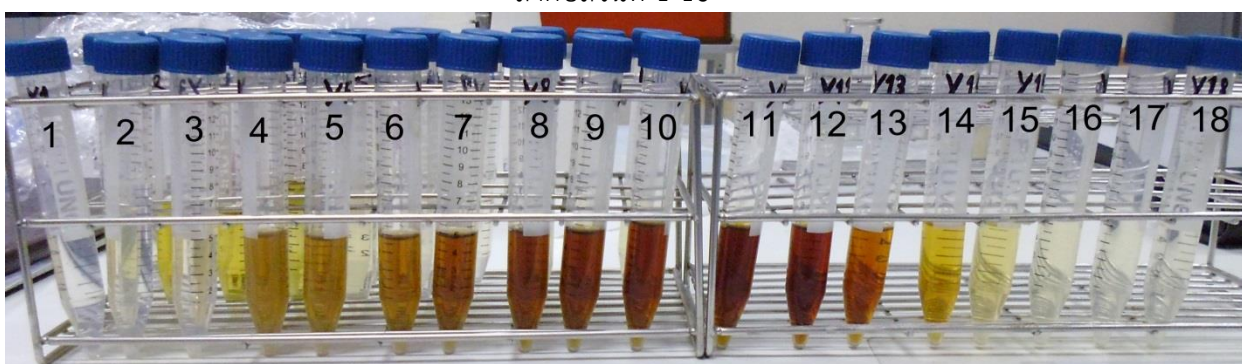
รูปที่ 4.9 สารสกัดลำดับส่วนจากสารสกัดหยาบฟักข้าวส่วนเยื่อหุ้มเมล็ดที่แยกด้วยเทคนิคเจลฟิลเตรชันโครมาโตกราฟีลำดับส่วนที่ 1-18
