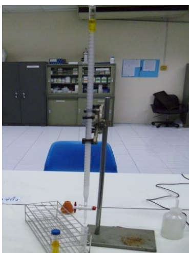
รูปที่ 4.7 โครมาโตกราฟีชนิดคอลัมน์ในการแยกสารประกอบของสารสกัดหยาบผักข่า
