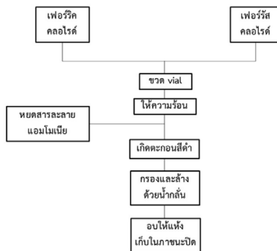
รูปที่ 2.1 แผนผังสรุปขั้นตอนการสังเคราะห์อนุภาคแม่เหล็กนาโนด้วยวิธีการตกตะกอนร่วม
