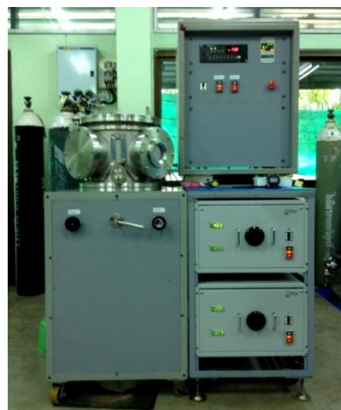
ภาพที่ 3-2 เครื่องเคลือบระบบสปัตเตอริงที่ใช้เคลือบในงานวิจัย
