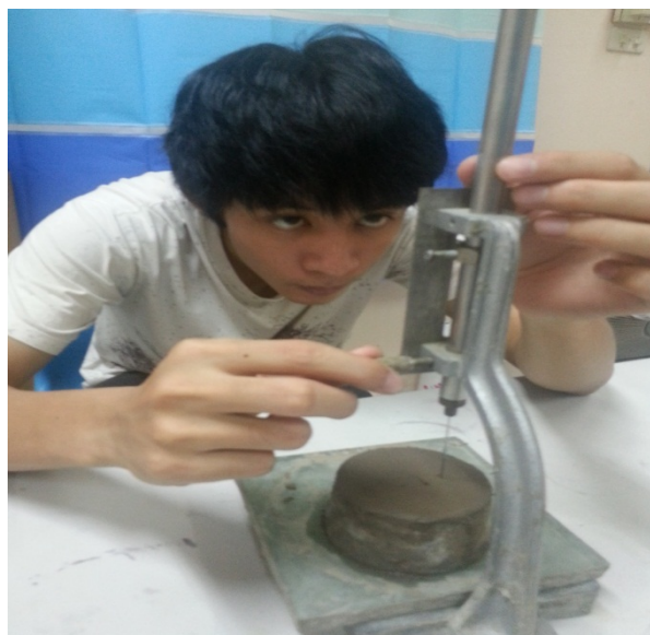
รูปที่ 3.13 การทดสอบหาการก่อตัวระยะต้นและระยะปลาย
