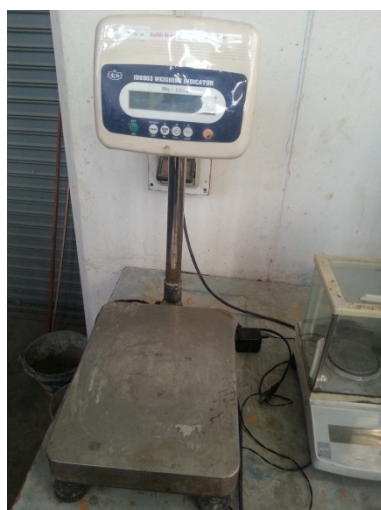
รูปที่ 3.5 เครื่องชั่งความละเอียด 0.02 กก.
