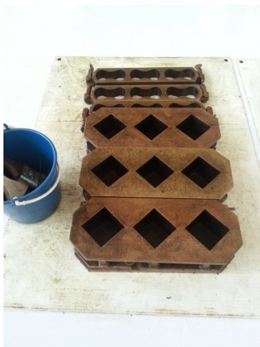
รูปที่ 3.7 แบบหล่อคอนกรีตขนาด 50x50x50 มม.
