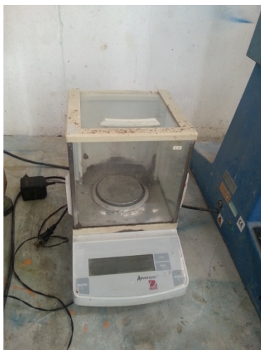
รูปที่ 3.6 เครื่องชั่งละเอียด 0.0002 กก.
