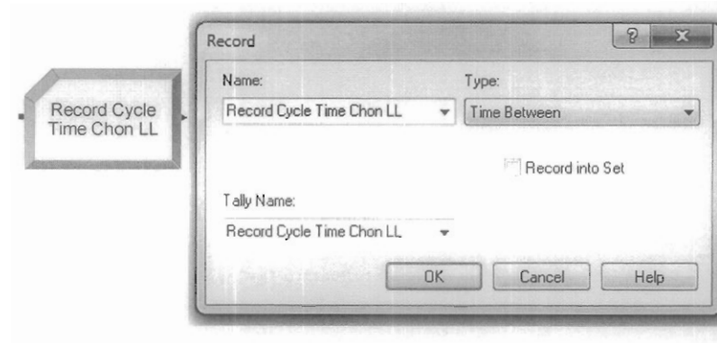
รูปที่ 4.21 ตัวอย่างการกำหนดค่าลงเรคคอร์ดโมดูล สำหรับบันทึกอัตราการออกของรถ
