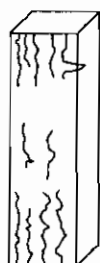
รูปที่ 4.2 การวิบัติของการรับแรงอัดของไม้ในแนวขนานเส้น
