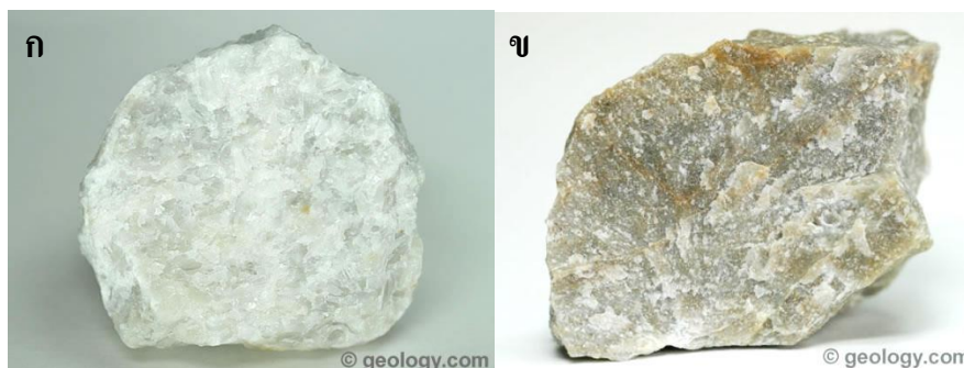
ภาพที่ 2-16 ลักษณะของแปรสภาพบริเวณไพศาลชนิดหินอ่อน (ก) และหินควอตไซต์ (ข) (Hobart, 2012)
