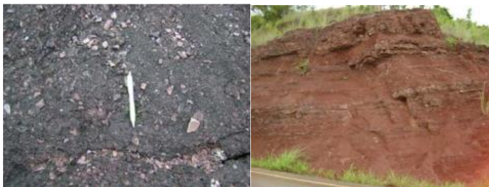
ภาพที่ 2-6 หินกรวดภูเขาไฟ (ซ้าย) และหินทรายแป้งสีน้ำตาลแดง หมวดภูกระดึง (ขวา) (กรมทรัพยากรธรณี, 2551)
