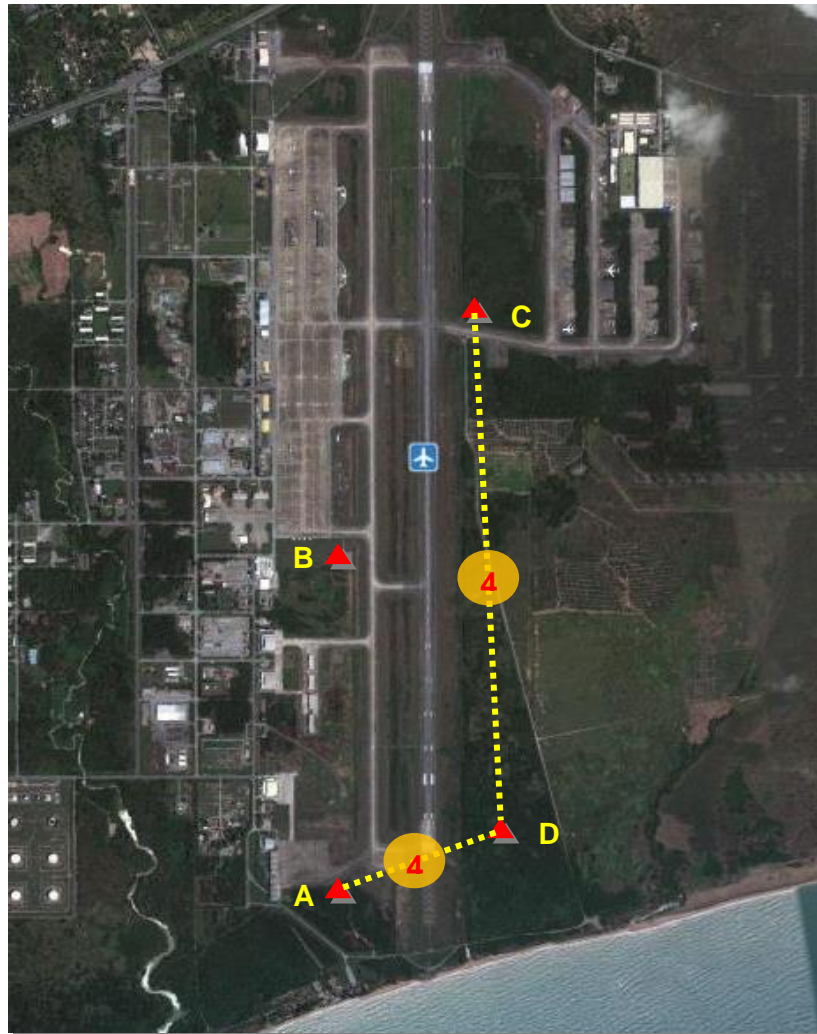
ภาพที่ 3-11 การรังวัดโครงข่ายรองภายในสนามบินอุตะเถา โดยใช้ หมุด A หมุด C และ หมุด D ในคาบที่ 4
