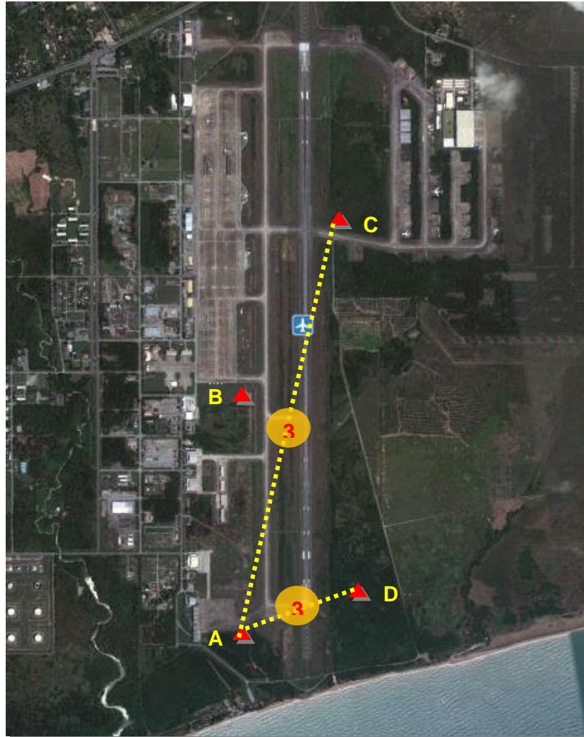
ภาพที่ 3-10 การรังวัดโครงข่ายรองภายในสนามบินอู่ตะเภา โดยใช้ หมุด A หมุด C และ หมุด D ในคาบที่ 3
