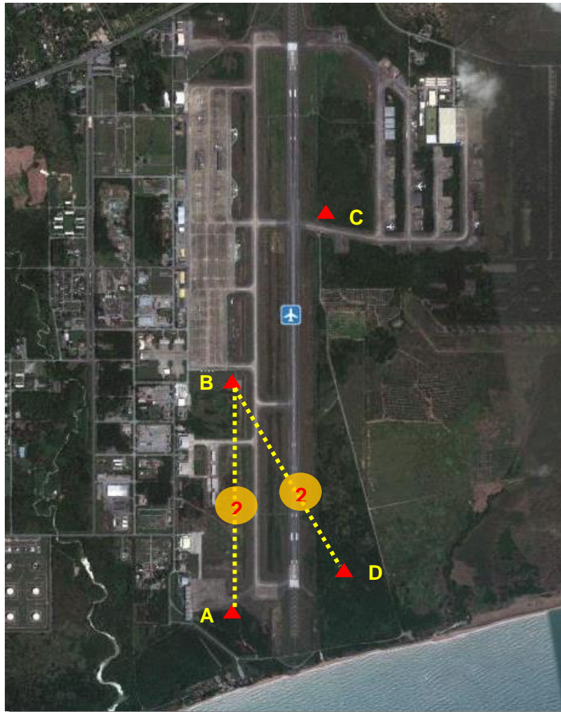
ภาพที่ 3-9 การรังวัดโครงข่ายรองภายในสนามบินอุตะเถา โดยใช้ หมุด A หมุด B และ หมุด D ในคาบที่ 2
