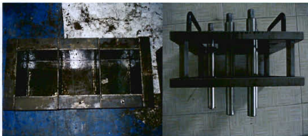
(ก) อุปกรณ์ที่ใช้ในการหล่อจีโอพอลิเมอร์คอนกรีต
