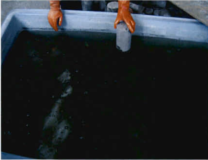
ภาพที่ 3-14 การแช่ตัวอย่างจีโอพอลิเมอร์คอนกรีตในสารละลายกรดซัลฟูริกความเข้มข้นร้อยละ 3 โดยน้ำหนัก และความเข้มข้นร้อยละ 5 โดยน้ำหนัก
