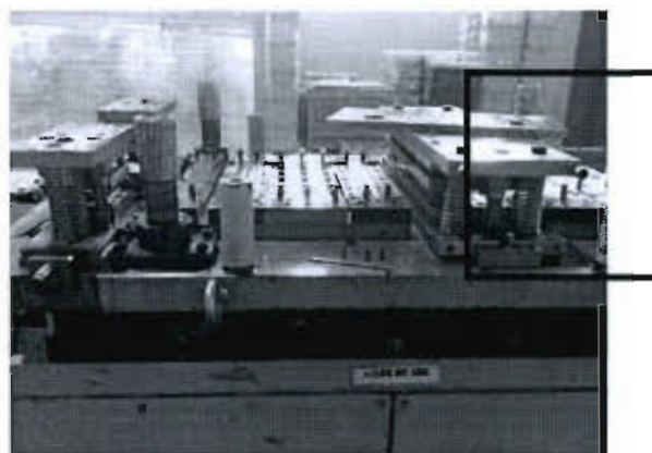
ภาพที่ 3-8 แม่พิมพ์ชนิดที่ 2 และตำแหน่งที่มีการถอดสลับเพื่อเปลี่ยนรุ่นผลิตภัณฑ์ที่เป็น TOP Plate
