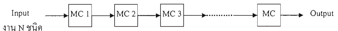
ภาพที่ 3-2 โครงสร้างของงานในระบบการผลิตแบบต่อเนื่อง (Pure Flow Shop)
