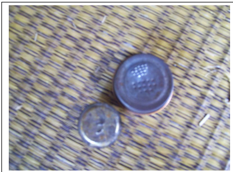
ภาพที่ 4-12 ฝากระป๋องเจาะรู เพื่อรูด กลลา เส้นตอกให้ได้ขนาดตามต้องการ
