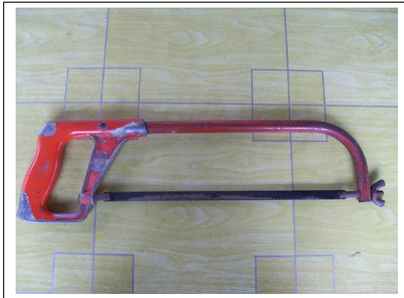
ภาพที่ 4-9 เลื่อย สำหรับตัดไม้ไผ่เป็นเครื่องมือที่สะดวกในการทำงาน
