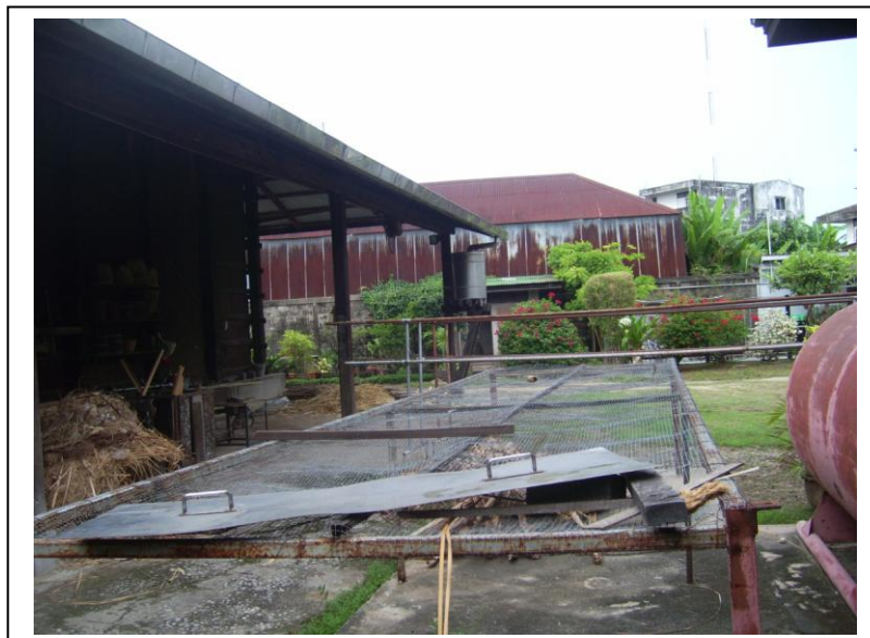
ภาพที่ 4-20 ตะแกรงสำหรับตากเส้นดอกไม้แห้งสนิทเพื่อไม่ให้เกิดเชื้อรา หรือมีกลิ่น
