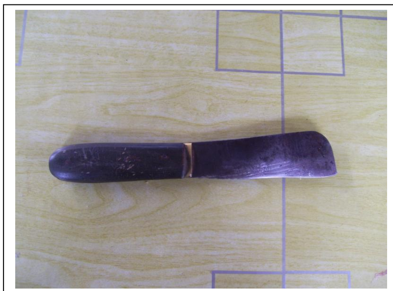
ภาพที่ 4-8 มีดบาง สำหรับเหลาไม้ไฟหรือไว้ลอกตอก
