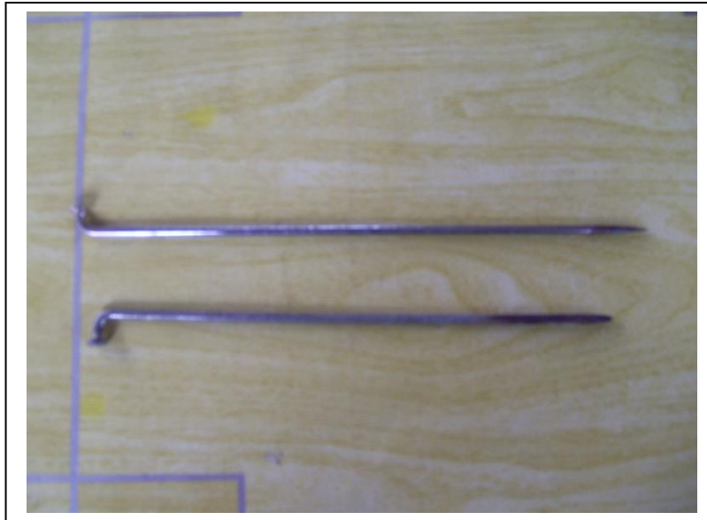
ภาพที่ 4-13 เหล็กแหลม สำหรับนำและจัดเรียงเส้นตอกให้เป็นระเบียบสวยงาม
