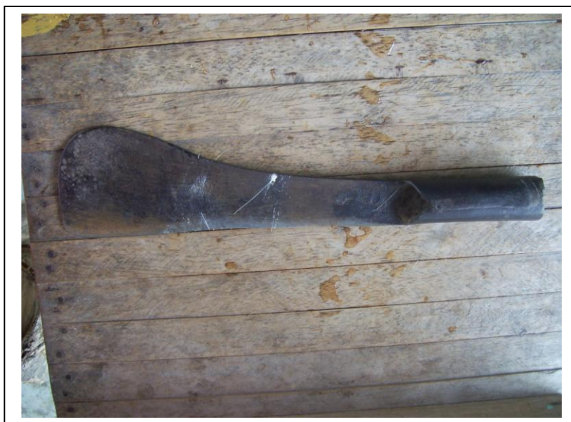
ภาพที่ 4-7 มีดีโต้ สำหรับผ่าไม้ไฟเป็นซีกก่อนที่จะนำไปจักตอก หรือสำหรับตัดข้อไม้
