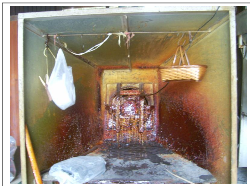
ภาพที่ 4-22 เตาพ่นน้ำยาเคลือบชิ้นงานที่ทำสำเร็จแล้ว เพื่อรักษาเนื้อไม้ให้แข็งแรงมากขึ้น และให้ความเงางามขึ้น
