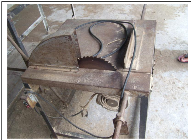
ภาพที่ 4-10 เครื่องตัดไม้ไผ่สำหรับตัดไม้ไผ่ในปริมาณมาก และเป็นการประหยัดเวลาในการทำงาน และไม่ทำให้เสียเนื้อไม้
