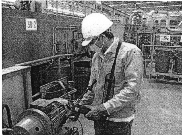
ภาพที่ 3-5 ตัวอย่างของการวัดค่าความสั่นสะเทือนพร้อมบันทึกค่าไว้ที่เครื่องวัดค่าความสั่นสะเทือน
