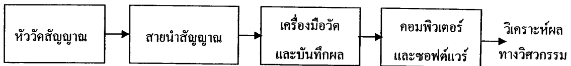
ภาพที่ 2-19 ส่วนประกอบสำหรับการวัดและวิเคราะห์สัญญาณการสั่นสะเทือน
