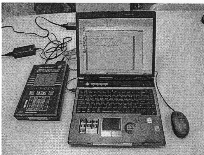
ภาพที่ 3-3 การโหลดข้อมูลเครื่องจักรของโรงงานอุตสาหกรรมเข้าไปเก็บไว้ที่เครื่องวัดค่า ความสิ้นสะท้อน
