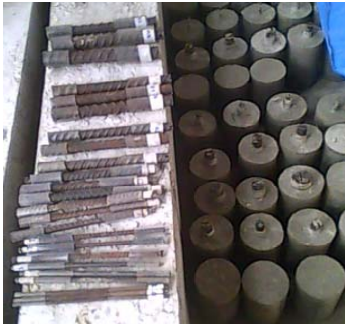
รูปที่ 3.3 เหล็กเสริมที่ใช้ในการทำตัวอย่างทดสอบ
