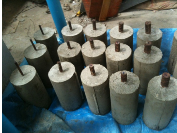
รูปที่ 4.2 คอนกรีตทรงกระบอกที่เสียบเหล็กขนาด RB9 DB12 DB16 DB20 DB25
