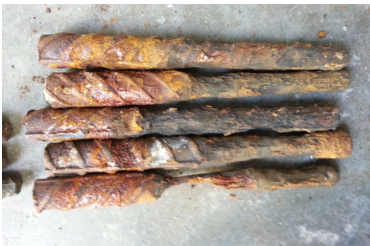
รูปที่ 4.7 ตัวอย่างเหล็กที่ออกมาจากคอนกรีตทรงกระบอก
