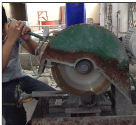
รูปที่ 3.3 การตัดตัวอย่างคอนกรีตเป็นชิ้นๆหนาชั้นละ 10 มม. เพื่อทดสอบปริมาณคลอไรด์
