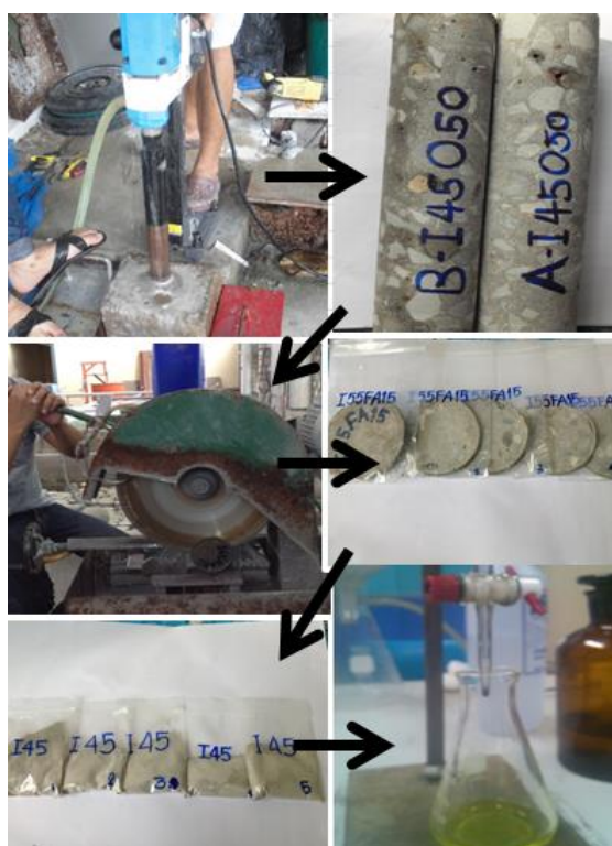
รูปที่ 3.5 การทดสอบการแทรกซึมของคลอไรด์ในคอนกรีตที่แช่น้ำทะเลที่อายุ 12 ปี
