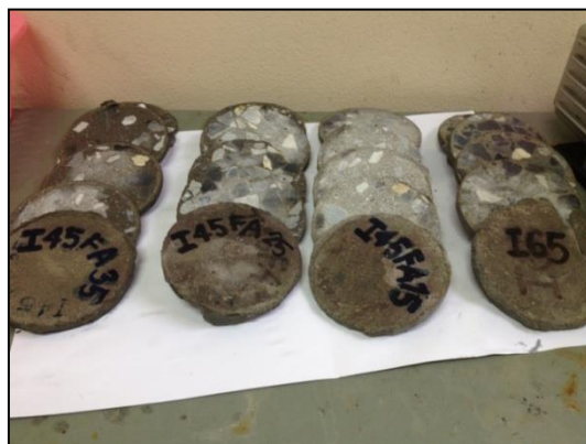
รูปที่ 3.3 การตัดตัวอย่างคอนกรีตเป็นชิ้นๆหนาชั้นละ 10 มม. เพื่อทดสอบปริมาณคลอไรด์
