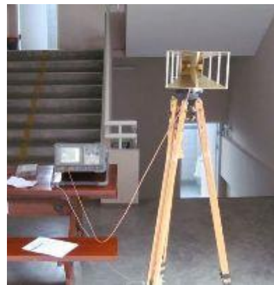
รูปที่ 4.2-13 การวัดทดสอบปริมาณการแผ่คลื่นของสายอากาศโดยสอบเทียบกับสายอากาศมาตรฐาน
