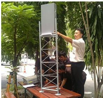
รูปที่ 4.2-13 การวัดทดสอบปริมาณการแผ่คลื่นของสายอากาศโดยสอบเทียบกับสายอากาศมาตรฐาน
