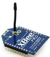
รูปที่ 1-3 อุปกรณ์ Wireless Sensor Network ที่ใช้ในงานวิจัย
