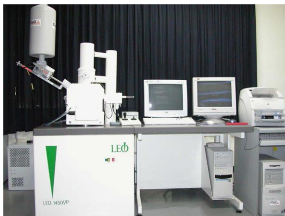
รูปที่ 2.16 แสดงกล้องจุลทรรศน์อิเล็กตรอนแบบส่องกราด ยี่ห้อ LEO รุ่นLEO 1450 VP ( http://www.microscopic.center.sci.buu.ac.th/ )
