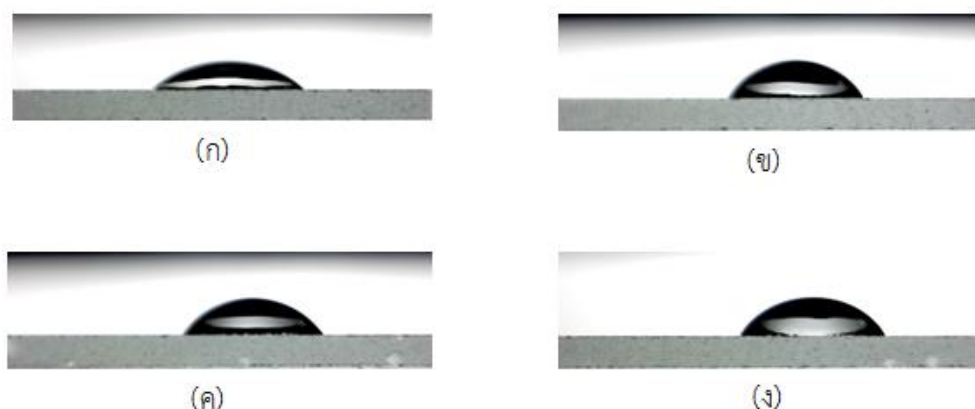
รูปที่ 4.14 แสดงภาพลักษณะของหยดน้ำบนกระจกที่เคลือบด้วยฟิล์ม โดยไม่มีการกระตุ้นด้วยแสง (ก) 30%TiO 2 , 65%SiO 2 และ 5%ZnO (ข) 30%TiO 2 , 60%SiO 2 และ 10%ZnO (ค) 30%TiO 2 , 55%SiO 2 และ 15%ZnO (ง) 30%TiO 2 , 50%SiO 2 และ 20%ZnO
