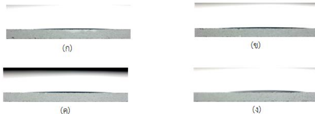
รูปที่ 4.17 แสดงภาพลักษณะของหยดน้ำบนกระจกเคลือบฟิล์มบาง 30\%TiO_2 , 55\%SiO_2 และ 15\%ZnO (ก) การกระตุ้นด้วยแสงอัลตราไวโอเล็ต (ข) หลังจากการกระตุ้นด้วยแสงอัลตราไวโอเล็ต และเก็บไว้ในกล่องมืด ควบคุมความชื้นสัมพัทธ์ร้อยละ 85 (ค) กระตุ้นด้วยแสงสีขาว (ง) หลังจากการกระตุ้นด้วยแสงสีขาว และเก็บไว้ในกล่องมืด ควบคุมความชื้นสัมพัทธ์ร้อยละ 85
