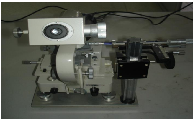
รูปที่ 2.17 แสดงเครื่องวัดมุมสัมผัส (Contact Angle Meter)
