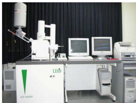
ภาพที่ 1 กล้องจุลทรรศน์อิเล็กตรอนแบบส่องกราด รุ่น LEO 1450 VP บริษัท LEO
