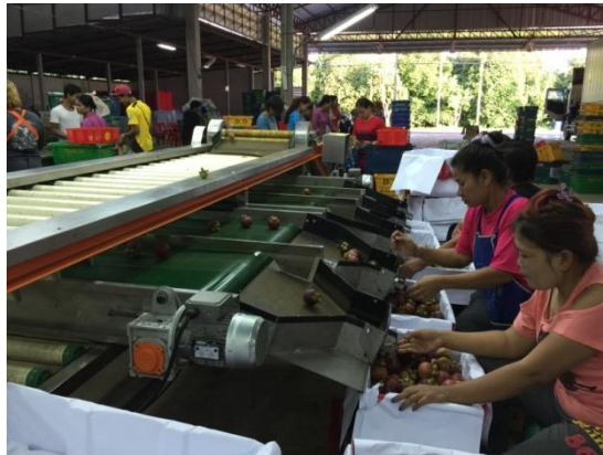
ภาพที่ 4-7 เครื่องคัดแยกขนาดบรรจุลงตะกร้า
