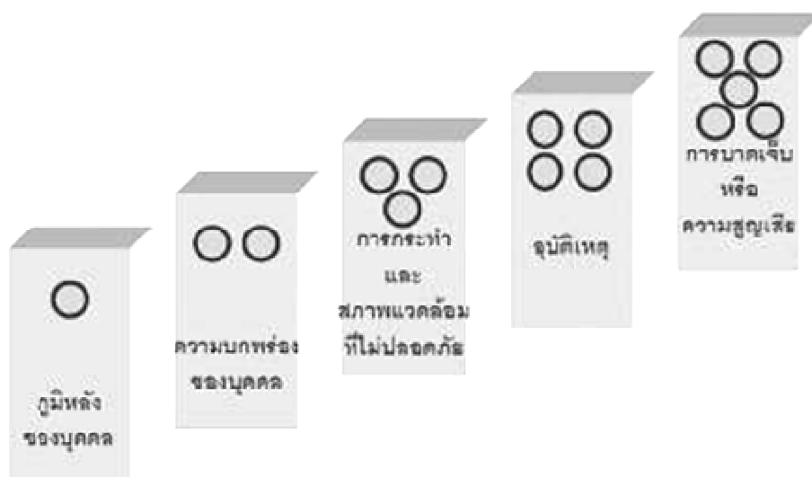
ภาพที่ 2-2 ลักษณะการเกิดอุบัติเหตุตามหลักทฤษฎีโดมิโน
