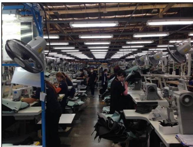
ภาพที่ 4-3 สายการผลิตการเย็บกระบวนการผลิต 4Q00
