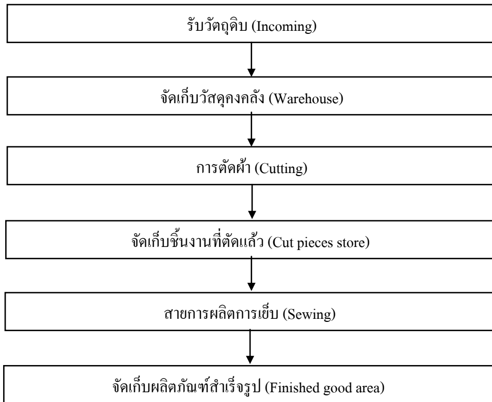
ภาพที่ 3-1 การไหลกระบวนการผลิตผ้าห่มเบาะรถยนต์ 4Q00
