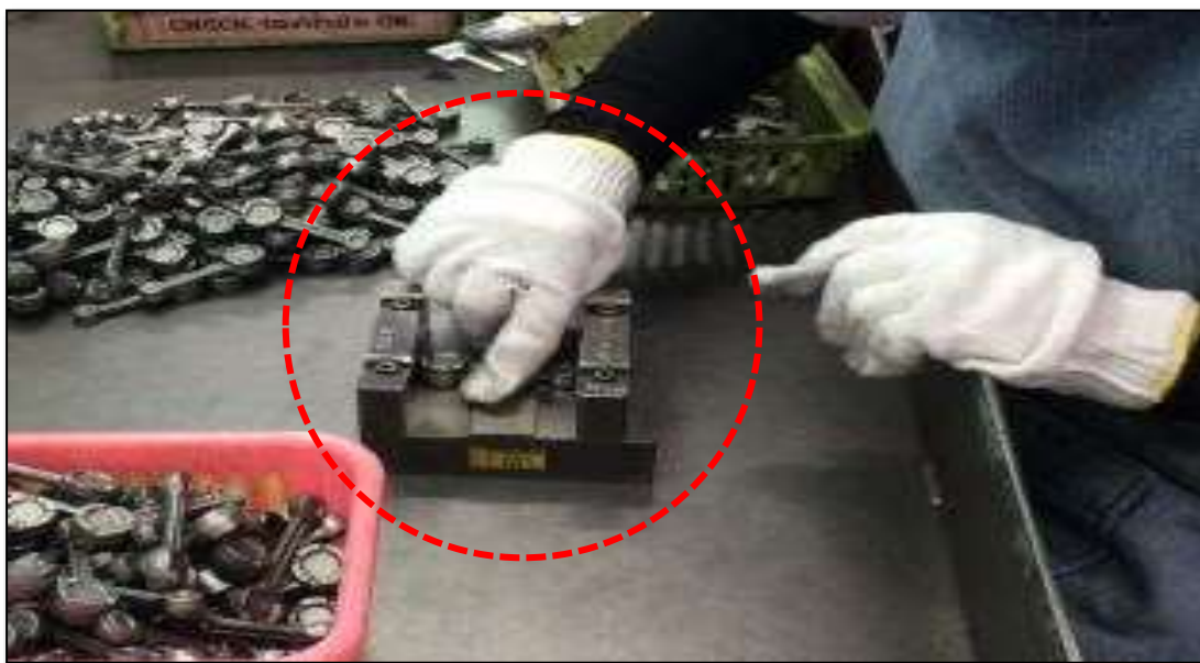
ภาพที่ 4-5 การใช้งานเครื่องมือตรวจจับของเสียของ Model conrod
