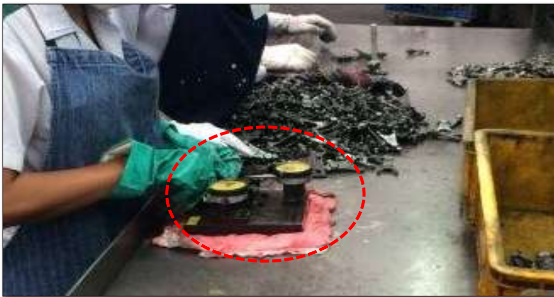
ภาพที่ 4-7 การใช้งานเครื่องมือตรวจจับของเสียของ Model fork gear
