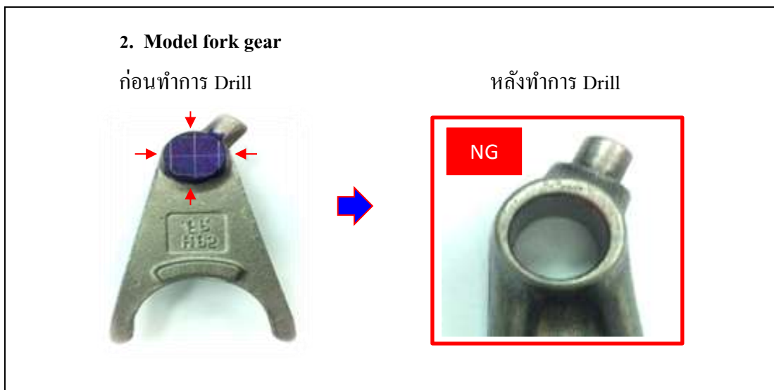
ภาพที่ 3-4 Model fork gear หลังทำการเจาะรูชิ้นงานไม่ได้ระยะ Center (NG)
