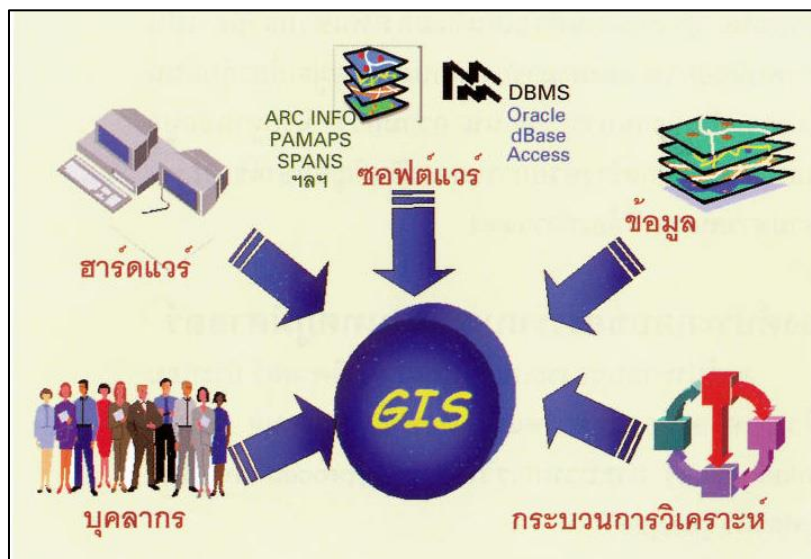
ภาพที่ 2-3 องค์ประกอบของระบบสารสนเทศภูมิศาสตร์ (GIS) (สำนักงานพัฒนาเทคโนโลยี อวกาศ และภูมิสารสนเทศ, 2557)
