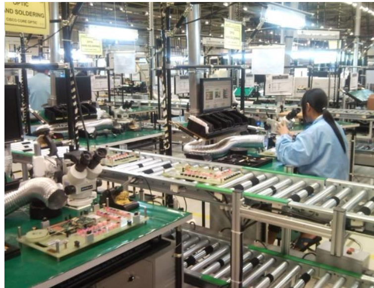
ภาพที่ 4-8 พนักงานหยิบงานชิ้นมาประกอบในส่วนที่ได้รับมอบหมาย จาก Line conveyor
