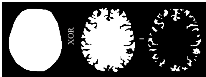
รูปที่ 4-8 ภาพแสดงขั้นตอนการสกัดร่องสมอง ส่วนที่ 1. เปลือกนูนสมอง 2.สมองที่เติมช่องว่าง 3.ร่องสมอง
