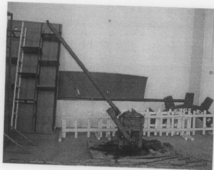
รูปที่ 3.1 เครื่องอัดคอนกรีตบล็อกชนิดซินวา-แรม (Cinva-ram)
