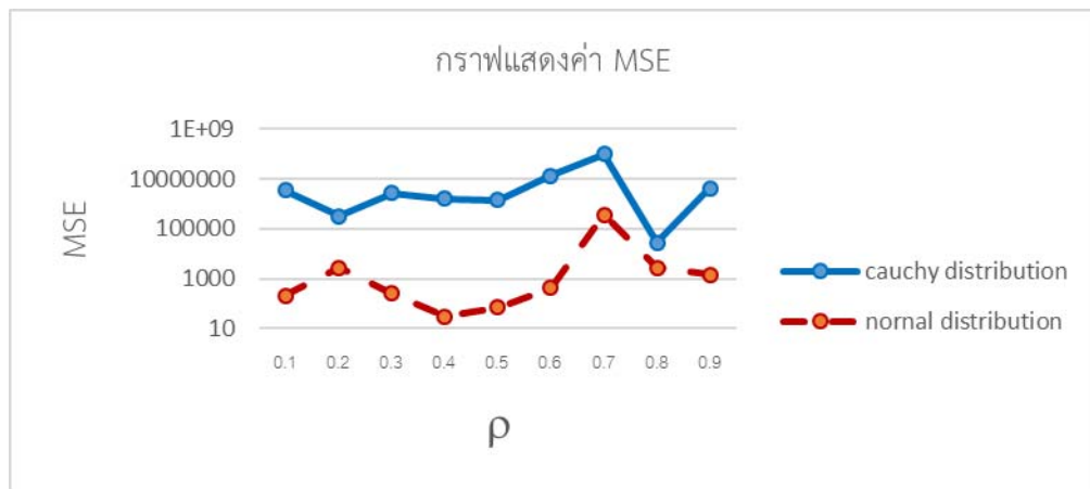
ภาพที่ 4-15 การเปรียบเทียบค่า MSE กรณีแบบนิวตันแบบ h_{SROT} = 0.9A(n^{\frac{1}{5}}) ตามการแจกแจงแบบโคชี (Cauchy) และการแจกแจงแบบปกติ (Normal) กรณี n = 10
