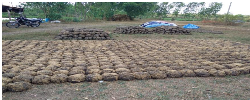
ภาพที่ 16 ดินเหนียวที่ผสมแกลบและหัวเชื้อแล้ว ปั้นเป็นก้อน ตากแดด ประมาณ 2-3 วัน
