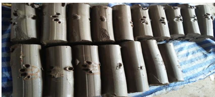
ภาพที่ 19 ดินที่ผสมเสร็จพร้อมนำไปปั้น
