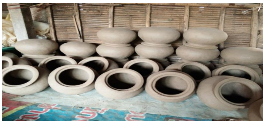
ภาพที่ 21 หม้อที่ปั้นเสร็จแล้วผึ่งไว้ประมาณ 3-4 วัน ก่อนนำไปเผา
