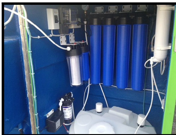
ภาพที่ 4 สภาพภายในของระบบการกรองของเครื่องจำหน่ายน้ำดื่มแบบหยอดเหรียญ ประเภทระบบการกรองของเครื่องจำหน่ายน้ำดื่มแบบหยอดเหรียญ
