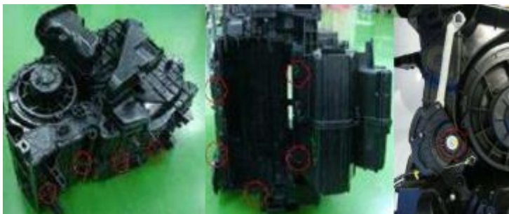
ภาพที่ 4-4 ชิ้นส่วนที่ทำการวัดขนาดที่ได้ตามแบบแล้วมาประกอบเพื่อทำการทดสอบความแข็งแรง จุดที่ทำการยึดสกรู
