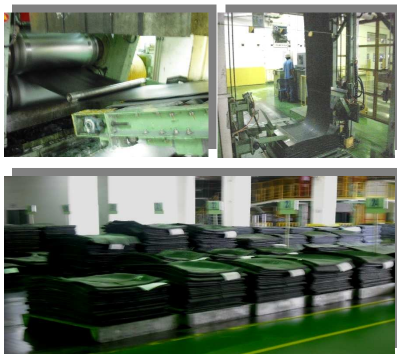
ภาพที่ 3-5 กระบวนการรีดยางและการเก็บยางใส่พาเลท
