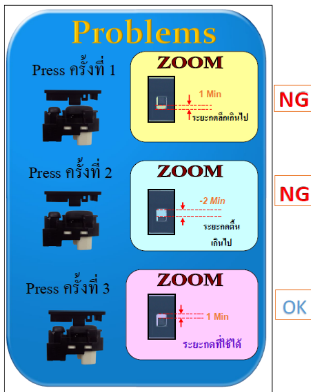
ภาพที่ 3-14 งานที่ประกอบ Bezel OK และ NG
