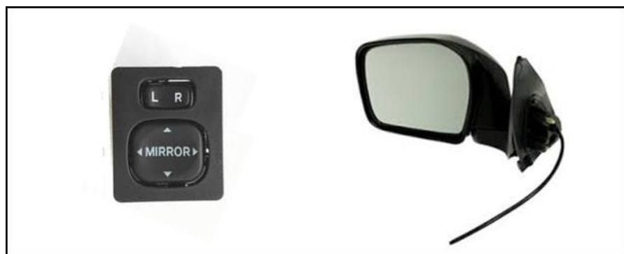
ภาพที่ 3-4 สวิตช์ควบคุมการปรับกระจกมองข้าง หรือ Switch outer mirror
