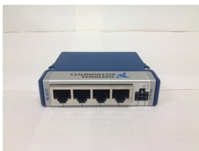
ภาพที่ 3-10 อุปกรณ์แปลงสัญญาณแบบบริดจ์ซึ่งใช้กับหัววัดการเปลี่ยนแปลงตำแหน่งหรืออุปกรณ์ตรวจวัดความเร่ง (Bridge transformer module)
