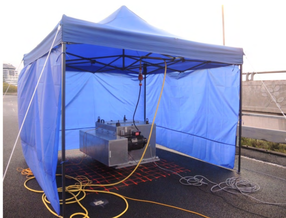
ภาพที่ 2-1 เครื่องให้การสั่นสะเทือนในแนวดิ่ง (Horizontal shaker) ที่ถูกติดตั้งบนสะพาน
