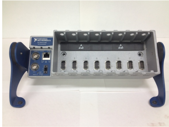
ภาพที่ 3-11 อุปกรณ์รวมสัญญาณยี่ห้อ National Instruments NI CDAQ 9178
