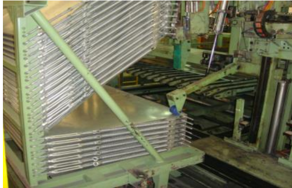
ภาพที่ 3-13 เครื่องบรรจุคอกยางและรถเก็บคอกยาง
