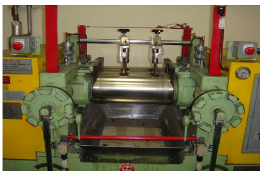
ภาพที่ 2-8 เครื่องผสมคอมพาวด์ชนิด 2 ลูกกลิ้ง
