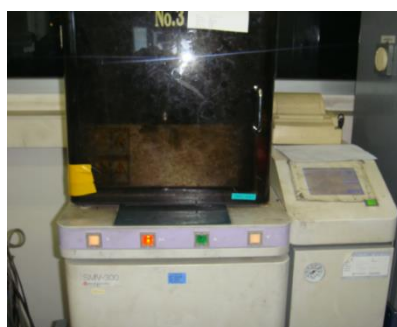
ภาพที่ 2-6 เครื่องวัดความหนืดมูนนี่ (Mooney viscosity) ของยางคอมพาวด์
