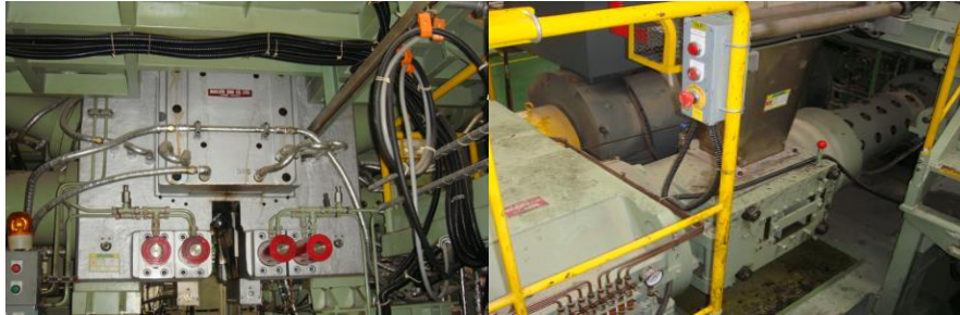
ภาพที่ 3-5 เอ็กทริเตอร์สำหรับ Cap คอมพาวด์
