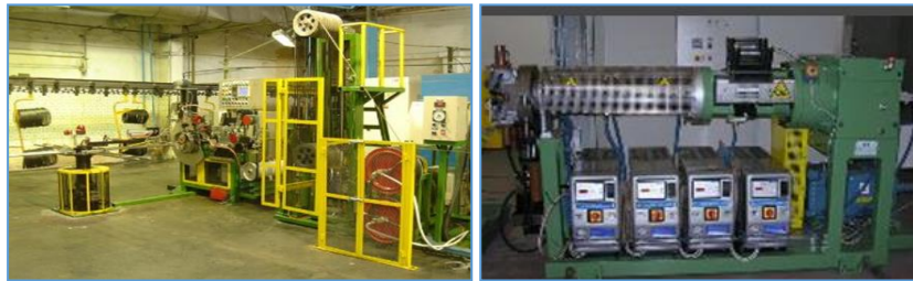
ภาพที่ 2-13 เครื่องผลิต Bead และ Apex เอ็กทรูเดอร์
