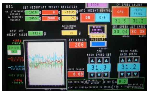
ภาพที่ 3-37 มาตรฐานของค่า ความเร็วของสายการผลิตและการปรับแบบ Manual
