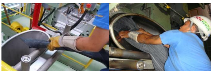
ภาพที่ 3-15 การป้อนยางเข้าเครื่องเอ็กทราuder
