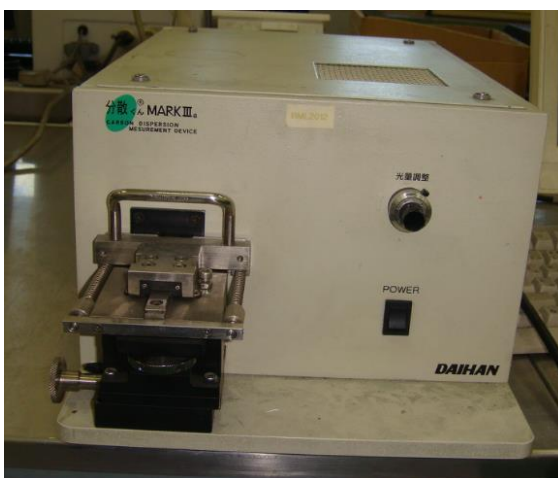
ภาพที่ 2-7 เครื่องวัดระดับการแตกตัวของสารตัวเติมของยางคอมพาวด์
