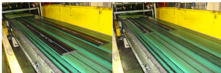
ภาพที่ 3-24 เครื่องซั้งที่ 3 ซั้งน้ำหนักรีดดอกยาง
