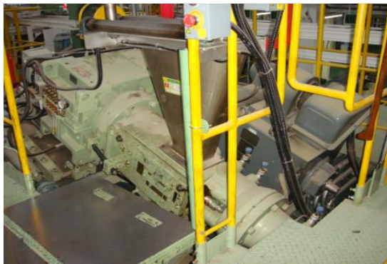
ภาพที่ 3-6 เอ็กทริเตอร์ สำหรับ Wing คอมพาวด์
