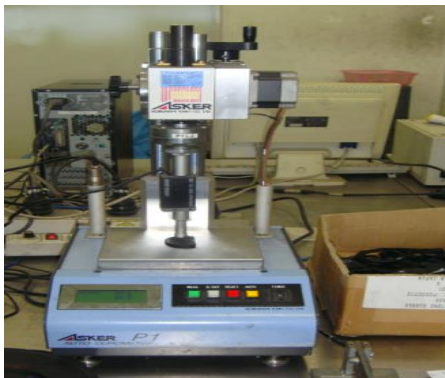
ภาพที่ 2-4 เครื่องทดสอบความแข็งของยางที่ผ่านการ Vulcanize แล้วชนิด Shore A
