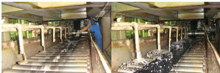
ภาพที่ 3-18 ดอกยางผ่าน Shock cooling
