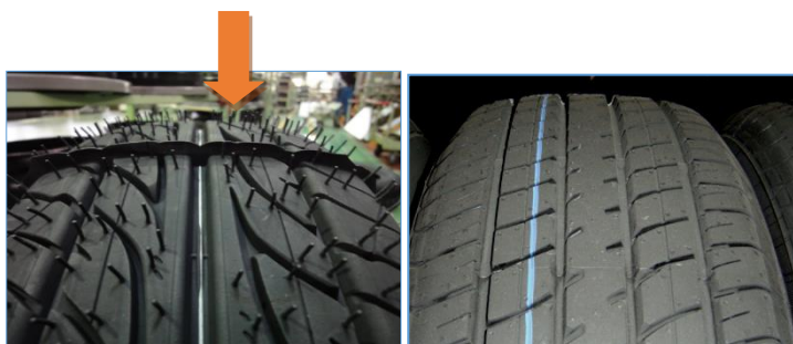
ภาพที่ 3-26 ลักษณะปัญหา Over spill
