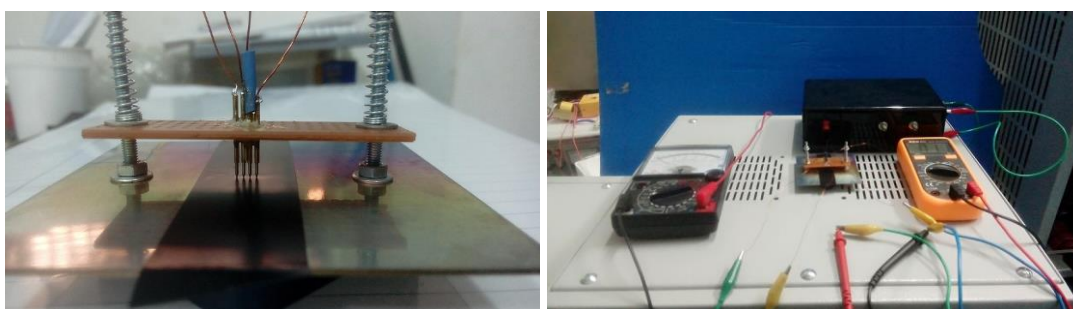
ภาพที่ 3-8 โฟร์พอยท์โพรบเชิงเส้นที่ใช้ในงานวิจัย
