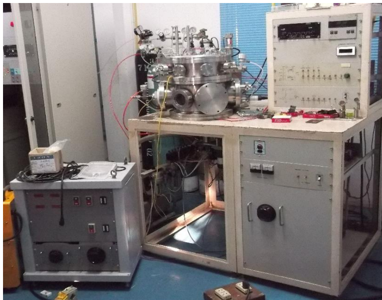
ภาพที่ 3-2 เครื่องเคลือบฟิล์มบางระบบ โค-สปัตเตอริง ที่ใช้ในงานวิจัย
