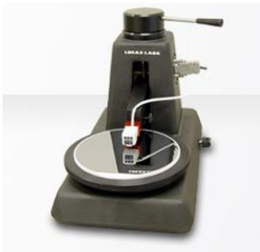
ภาพที่ 2-28 เครื่องวัดแบบ โฟร์พอยท์โพรบ (Four-point probe)
