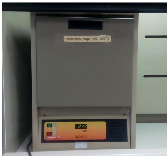
ภาพที่ 3-3 เตาสำหรับอบอ่อนฟิล์มบาง
