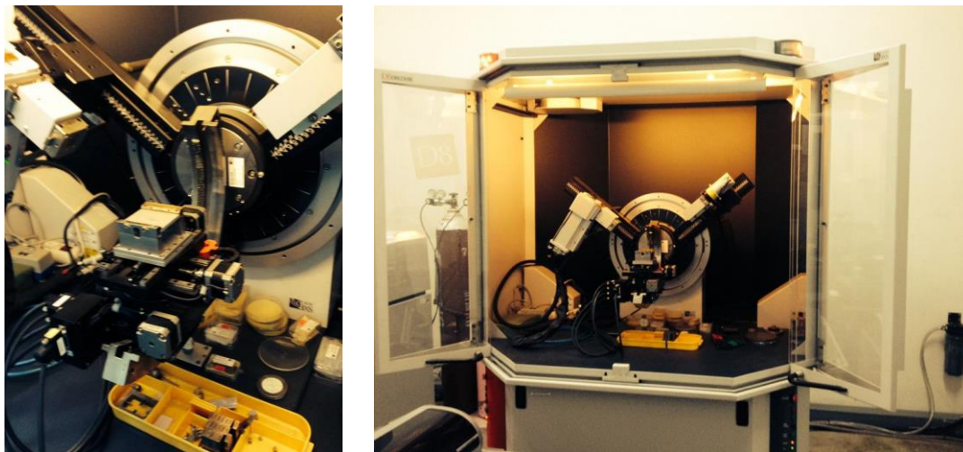
ภาพที่ 3-4 เครื่อง X-Ray Diffractometer (XRD)
