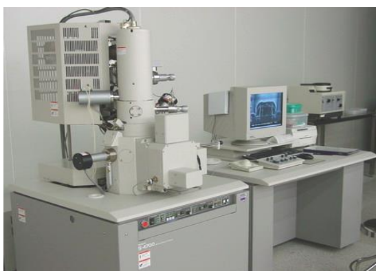
ภาพที่ 3-5 เครื่อง Field Emission Scanning Electron Microscope (FE-SEM)
