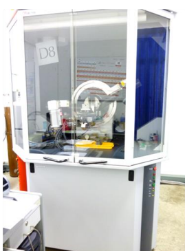
ภาพที่ 3-3 เครื่อง X-Ray Diffractometer (XRD)
