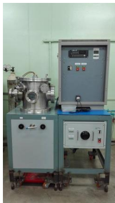
ภาพที่ 3-2 เครื่องเคลื่อนย้ายสุญญากาศระบบปริแอกติฟดีซีแมกนีตรอนสปัตเตอร์ที่ใช้ในงานวิจัย
