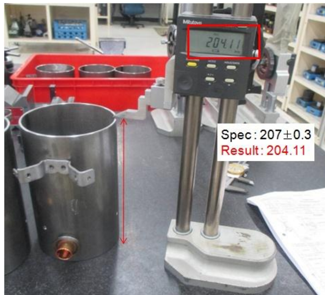
ภาพที่ 4-7 ตัวอย่างชิ้นงานผิดขนาด (Out of spec)
