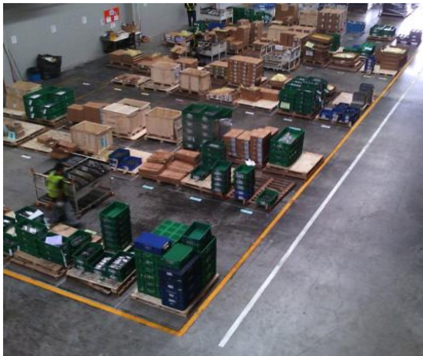
ภาพที่ 4-14 พื้นที่จัดเก็บสินค้า (หลังการปรับปรุง) แบบกำหนดพื้นที่ตายตัว (Fixed Location System) โดยแยกให้สินค้าแต่ละชุดอยู่ในแถวเดียวกัน
