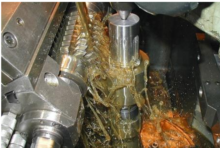
ภาพที่ 4-9 กระบวนการหล่อเย็นชิ้นงาน ระหว่างกระบวนการผลิต (เนเดอร์แมน, 2559)
