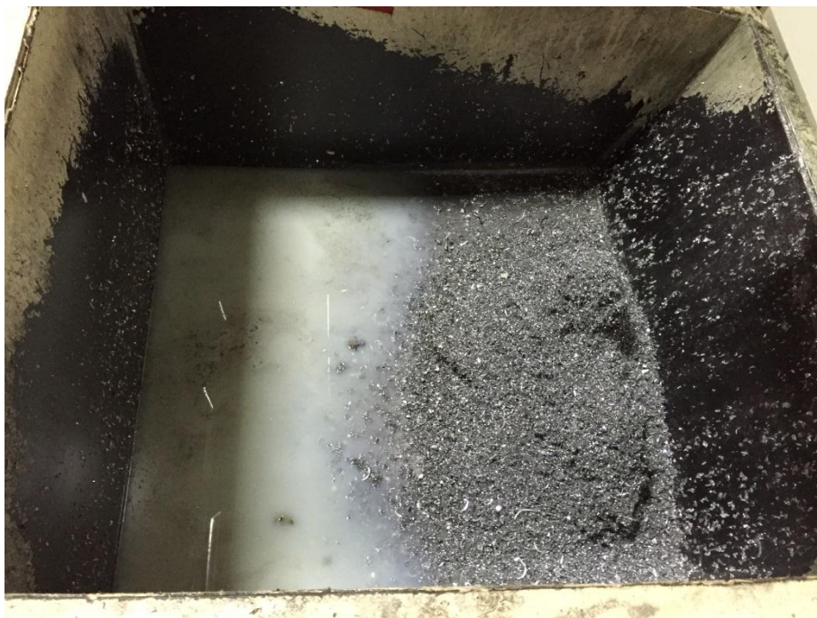
ภาพที่ 4-6 สารหล่อเย็นปนเปื้อนเศษวัสดุโลหะ
