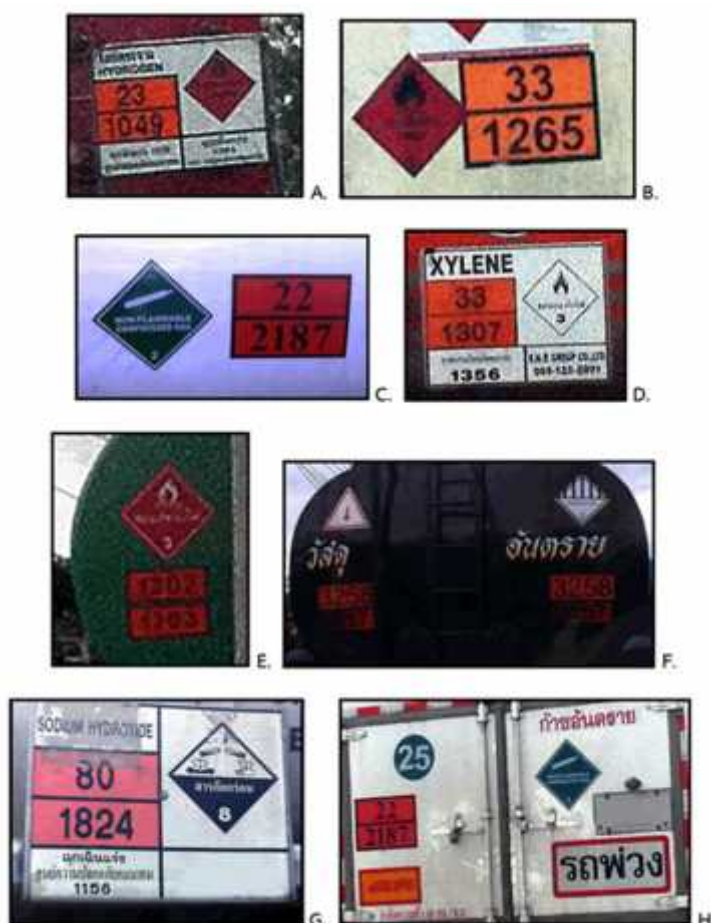
ภาพที่ 2-4 ตัวอย่างสัญลักษณ์ระบุนอันตรายที่ติดอยู่ข้างรถบรรทุกสารเคมี
