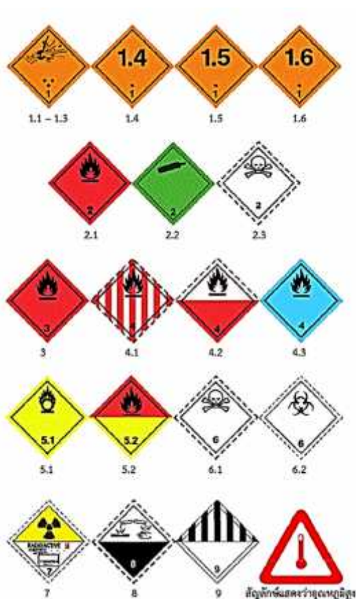
ภาพที่ 2-3 ภาพสัญลักษณ์ระบุอันตรายของสารเคมี ตามการแบ่งกลุ่มของสหประชาชาติ
