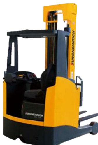
ภาพที่ 4-9 Reach Truck (บริษัท ยูนิค เวิร์ทอล แอนด์ เซอร์วิส จำกัด, 2558)
