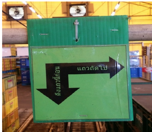
ภาพที่ 4-11 ลูกศรชี้บ่งให้หยิบงานบน Roller
