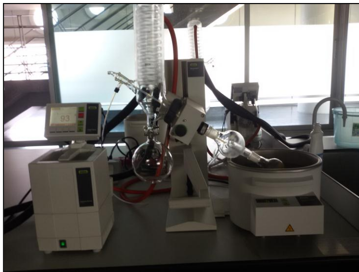
ภาพที่ 2-2 เครื่องระเหยลดความดันแบบหมุน
