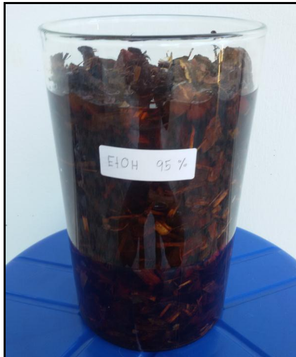
ภาพที่ ก-1 การสกัดอุ่นป่าส่วนรากด้วยตัวทำละลายเอทานอล 95%
