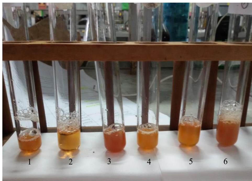
ภาพที่ ข-3 การทดสอบซาโปนิน
