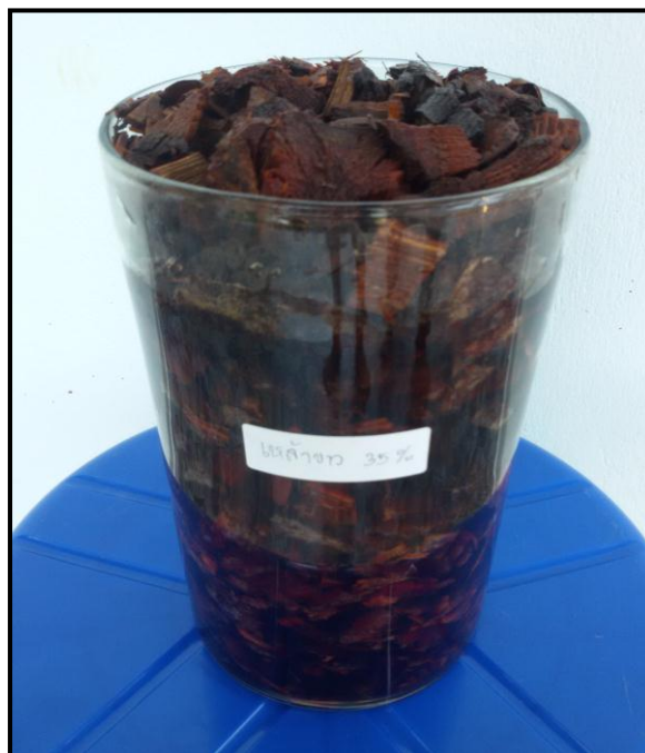
ภาพที่ ก-2 การสกัดอุ่นป่าส่วนรากด้วยตัวทำละลายเอทานอล 35%
