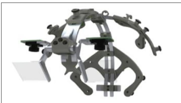
ภาพที่ 53 หมวกที่ประกอบด้วยระบบติดตามดวงตาและคลื่นไฟฟ้าสมอง (Valbuena et al., 2011, p.
