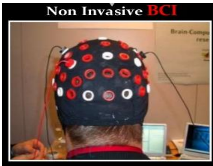
ภาพที่ 19 แบบจำลองการบันทึกสัญญาณคลื่นไฟฟ้าสมองภายนอกหนังศีรษะ (Millan, Ferrez, & Buttfeld, 2005, p. 17)
