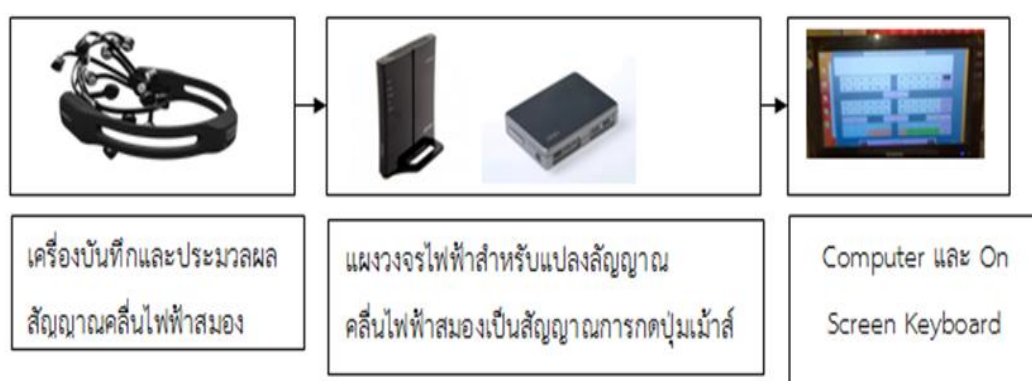
ภาพที่ 78 ภาพฝั่งการทำงานของฮาร์ดแวร์และซอฟต์แวร์ระบบการสื่อสารระหว่างสมองกับคอมพิวเตอร์ สำหรับควบคุมการกดปุ่มเมาส์
