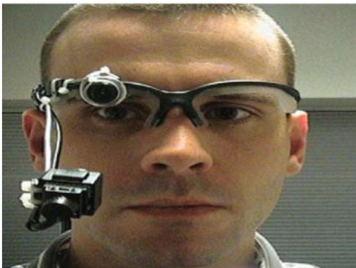
ภาพที่ 51 การบันทึกสัญญาณการเคลื่อนไหวดวงตาด้วยภาพเคลื่อนไหว (Video Oculography: VOG) (Newman-Toker, 2013, p. 1159)
