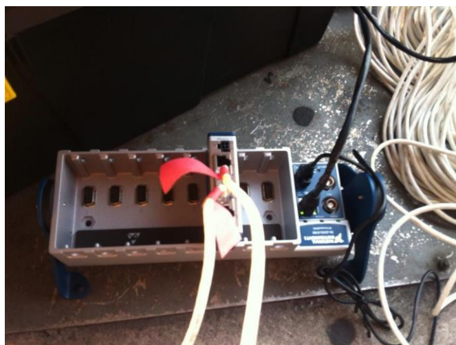
ภาพที่ 3-13 การต่อโมดูลแปลงสัญญาณวงจรแบบบริดจ์ (Bridge signal module) เข้ากับเครื่องรวมสัญญาณความถี่สูงแบบหลายช่องสัญญาณ (High frequency multi-channel data acquisition unit)
