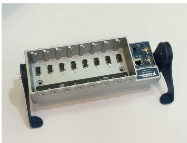
ภาพที่ 3-5 เครื่องรวมสัญญาณความถี่สูงแบบหลายช่องสัญญาณ (High frequency multi-channel data acquisition unit)
