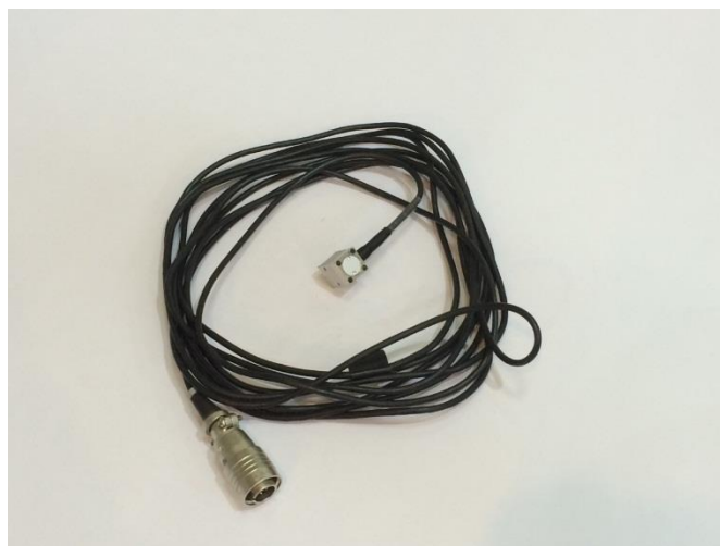
ภาพที่ 3-3 หัววัดขนาดความเร่ง (Acceleration transducer)
