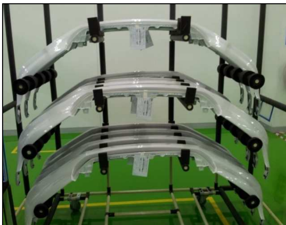
ภาพที่ 4-1 การจำลองนำชิ้นงานกันชนหน้ามาทดสอบการจัดเก็บ
