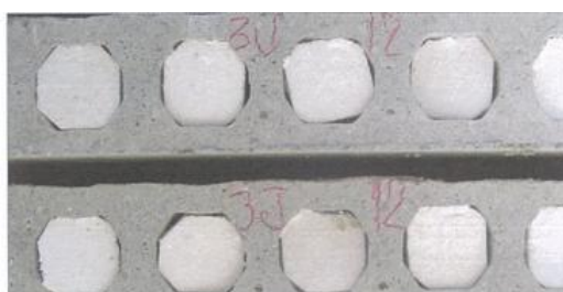
ภาพที่ 2-74 แผ่นพื้น Hollow core ที่มีการอุดรูด้วยโฟม (เทอดธรรม ยอดพฤติการณ์, 2555)
