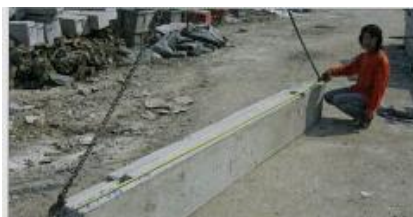
ภาพที่ 2-45 การวัดขนาดของคานและตำแหน่ง (เทอดธรรม ยอดพฤติกัณณ์, 2555)
