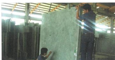
ภาพที่ 2-95 การตรวจสอบการบิดตัวของแผ่นผนัง (เทคธรรม ยอดพฤติกาณ์, 2555)
