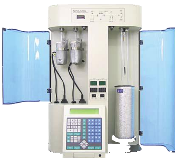
ภาพที่ 3-1 เครื่องมือทดสอบการดูดซับแก๊สไนโตรเจนทางกายภาพ ( BET Surface Area Analyzers , n.d.)
