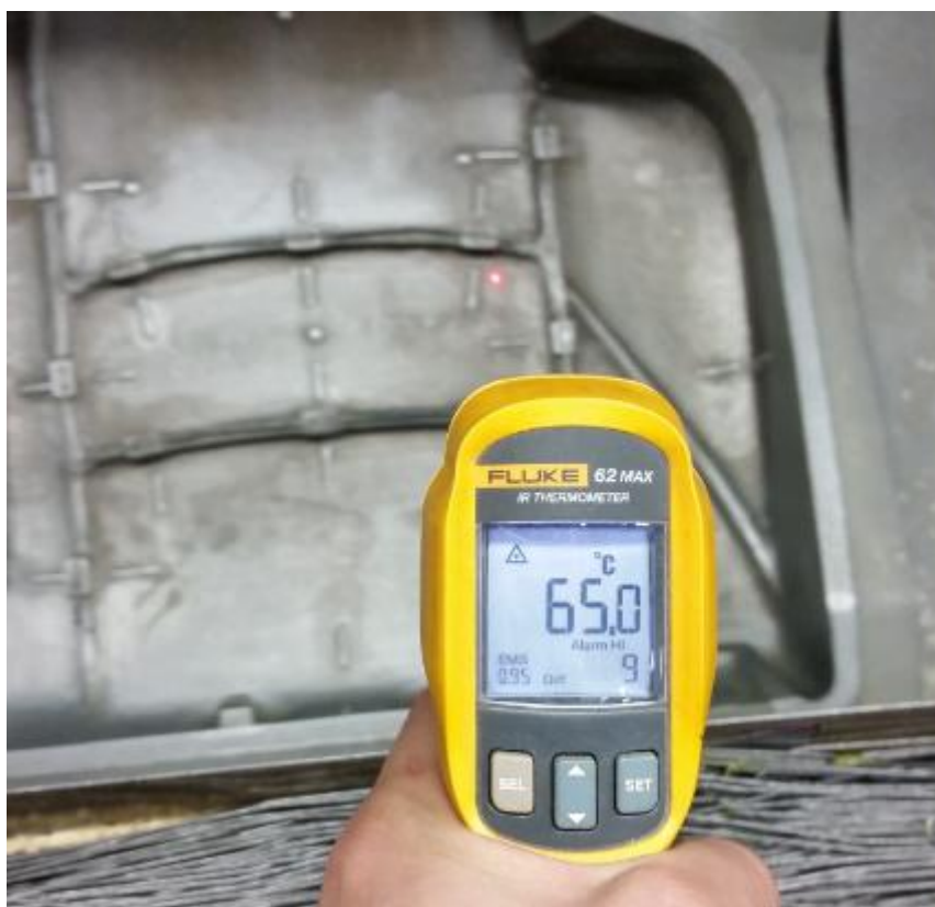
ภาพที่ 4-5 การตรวจสอบอุณหภูมิแม่พิมพ์หลังการปรับเพิ่มอุณหภูมิ
